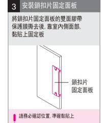
※ 安裝鎖扣片固定面板時,鎖扣片固定面板的刻印標示 和室內部的U型框架位置需保持一致(請參考下面圖片)
