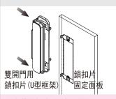
● 安裝鎖扣片時,請不要強制 ● 扳開鎖扣片的U型框架
